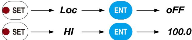
從確認顯示的狀態回到測試模式後，按下面的操作順序設定其它項目。
