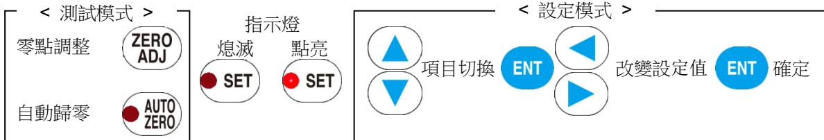
測試模式時輸出外部輸出信號 RDY 信號。設定模式時不輸出 RDY 信號。
