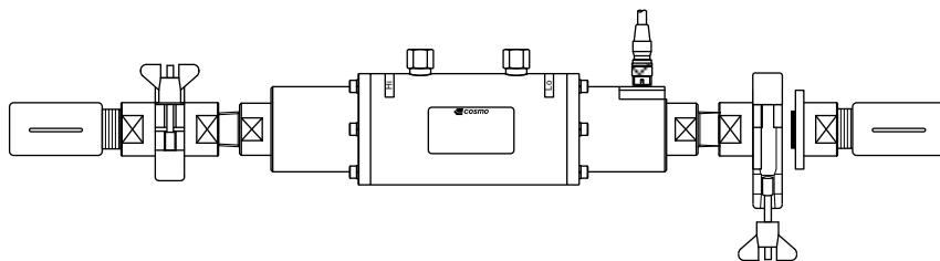
(2) 用螺絲把層流管固定在面板上，再使用尼龍管進行配管的方法。(LF-104N)
