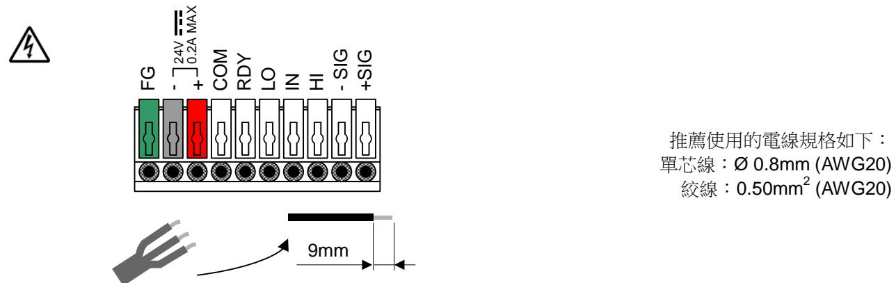
如果用螺絲起子等推按長方形按鈕的凹陷部位，該按鈕的狀態將由鎖定變為打開，只有在打開的狀態下才能插入電線，插入電線後請將按鈕扳回到原來的位置。
